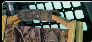
クォーターガラス全面をカバーする形状の為、背の高い荷物を積んだ時のガラスの保護にも活躍
