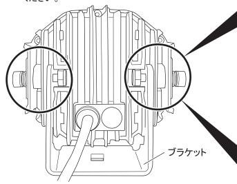
② ランプ左右の M6 ボルトを緩め、 取付ける向きやスペースに合わせて 上下角度の調整を行ってください。 調整後は振動等でランプが傾かないよう しっかり締付をしてください。
