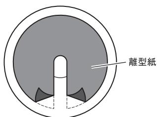
2. リフレックスリフレクタ裏面の離型紙を剥がし、貼り付けます。
