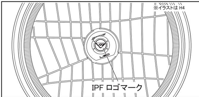
ヘッドランプを車両正面から確認し、左図のようにLEDバルブ先端の『IPF ロゴマーク』が水平になっていることを確認してください。
