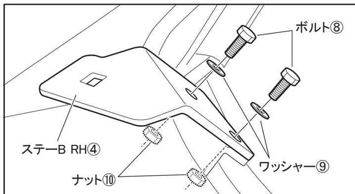
6. 角根ボルト⑪とランプに付属のナット、ワッシャーを使用し、図のようにランプを固定してください。
