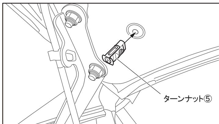
2. 挿し込んだターンナット⑤をトラスネジ⑥にて回転させ、ねじ山がかみ合ったら、右図のようにトラスネジ⑥を手前に引き、車両パネルをはさみ込んだらトラスネジ⑥を取り外してください。
