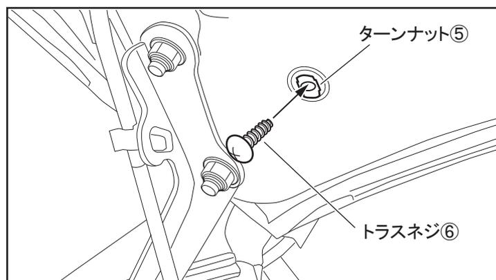
3. ボンネットをボンネットヒンジに固定しているナットを取り外し、ステア RH②(LH①)を右図のようにボンネットヒンジに共締めしてください。
