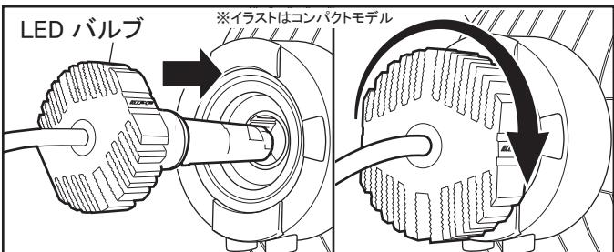
LED バルブを口金にまっすぐ奥まで差し込み、右回り(時計回り)に回転させて固定してください。
