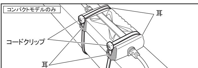
付属のコードクリップをドライバユニットの耳に通し、ヘッドライトユニット周辺の適切な場所に固定します。
