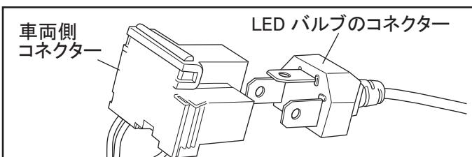
コネクターの向きに注意して、車両側のコネクターに LED バルブのコネクターを奥までしっかりと差し込んでください。ヘッドライトユニットを取り外して作業を行った場合は、取り外した部品を全て組み付けてください。
