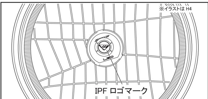
ヘッドライトを車両正面から確認し、左図のように LED バルブ先端の『IPF ロゴマーク』が水平になっていることを確認してください。
