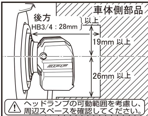
取り付け前に必ず取り付ける現車のバルブ後方スペースが28mm以上かつ上部19mm、下部26mm以上あるかどうかを確認してください。
