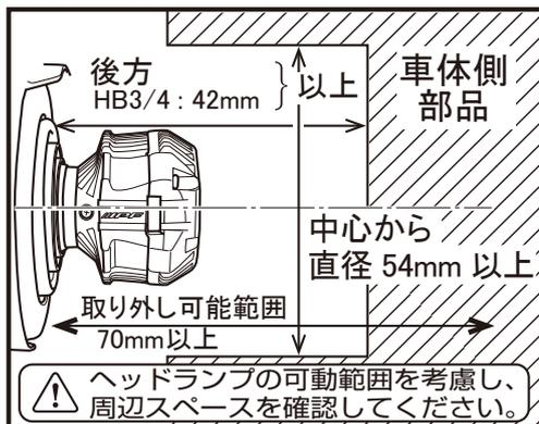
取り付け前に必ず取り付ける現車のバルブ後方スペースが42mm以上かつ直径54mm以上あるかどうかを確認してください。
