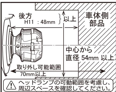
取り付け前に必ず取り付ける現車のバルブ後方スペースが48mm以上かつ直径54mm以上あるかどうかを確認してください。
