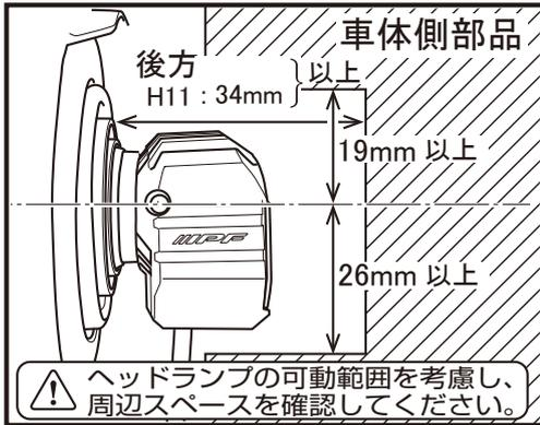
取り付け前に必ず取り付ける現車のバルブ後方スペースが34mm以上かつ上部19mm、下部26mm以上あるかどうかを確認してください。
