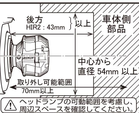
取り付け前に必ず取り付ける現車のバルブ後方スペースが43mm以上かつ直径54mm以上あるかどうかを確認してください。
